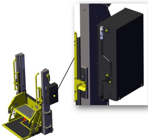
Localizar a manivela na caixa protetora do motor.
