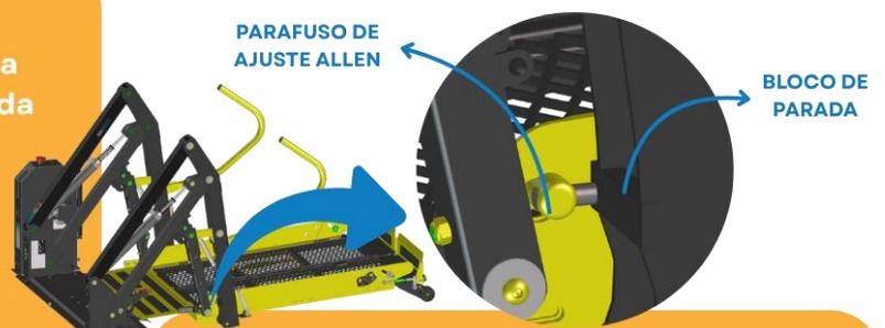
Após o ajuste do ângulo da plataforma, defina o posicionamento no nível do piso da plataforma, conforme detalhado no ajuste do microinterruptor da torre. Verifique o ângulo da plataforma novamente depois de executar os procedimentos de ajuste do microinterruptor da torre
