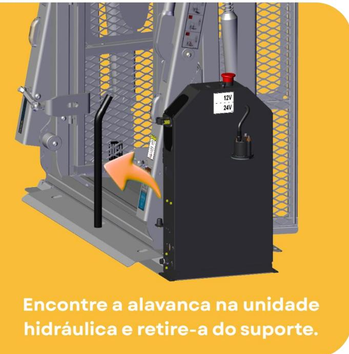
A alavanca de acionamento manual possui um recorte para que se encaixe na válvula de alívio, que se encontra no lado oposto ao suporte.
